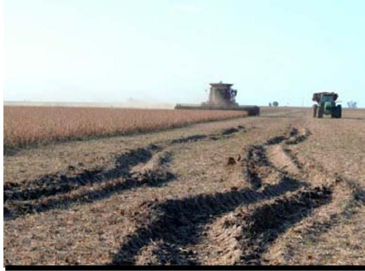
Pero, si las condiciones son de un cultivo volcado y cosechando en contra del sentido del vuelco, la velocidad del molinete debería ser solo un 9-10 % mayor a la velocidad de avance de la máquina. En cambio, si la recolección es en el mismo sentido de vuelco la velocidad del molinete puede ser 50 % mayor a la velocidad de avance.
